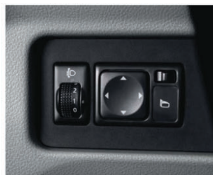
elektrické ovládanie vonkajších spätných zrkadiel a nastavenie sklonu svetlometov
