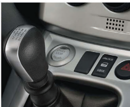
štartovanie motora tlačidlom (v spolupráci s inteligentným kľúčom)
